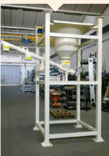
La struttura POFER SBB Svuota Big-Bag, fornita con o senza coclea estrattrice, è impiegata per lo svuotamento di sacchi di dimensioni e pesi diversi, contenenti materiali in polvere o in granuli di varia natura. La versione leggera (SBB L) consente un peso massimo di 1.000 Kg per i big-bags da sorreggere nello svuotamento. Mentre la versione pesante (SBB P) consente un peso massimo di 2.000 Kg.
