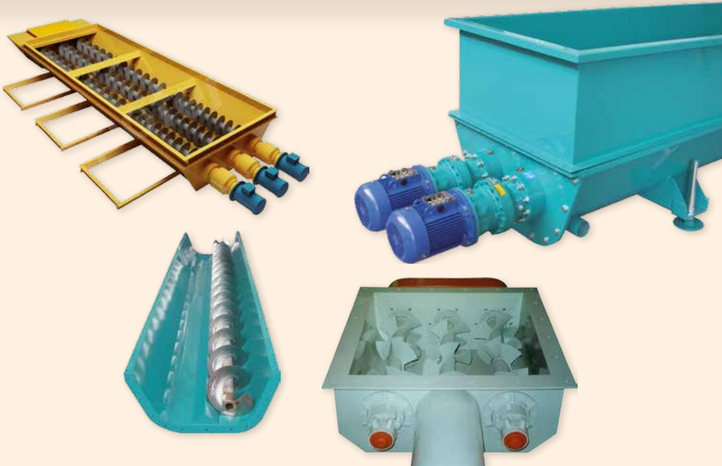
Questa tipologia di trasportatori a coclea a truogolo o canala con sezione a "U" e "V" o OTTAGONALE, viene progettata utilizzando lamiere e materiali come acciaio al carbonio o inox, e per le spirali acciaio al creusabro, hardox, con spessori importanti.
