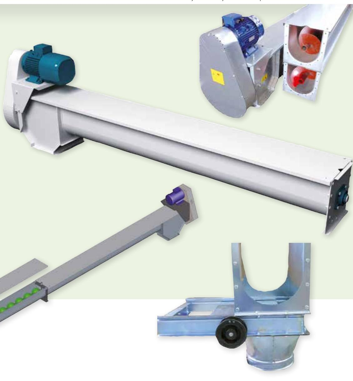
Coclea a canala adatta al trasporto di materiali granulosi e secchi. Le prolunghe sono componibili e modulari, con supporti intermedi in bronzo o plastica autolubrificante, maintenance free. Di serie viene proposta con trasmissione a cinghie RPM280 e RPM360, ma in base alle esigenze di portata è possibile fornire con trasmissione a catena o diretta.
