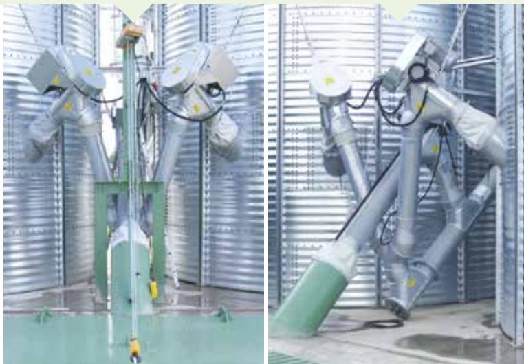
Convogliatore a coclea per uso agro-industriale con prolunghe flangiate e terminali modulari, realizzato in acciaio zincato a caldo, con supporti intermedi con ingassatori.
