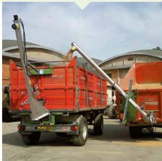
Convogliatori a coclea azionate da motore idraulico appositamente studiate per risolvere il problema del carico dei fertilizzanti in aperta campagna o dello svuotamento rimorchi. Vengono facilmente applicate dietro qualsiasi rimorchio dotato di sistema idraulico per il sollevamento del cassone. L'applicazione del motore idraulico permette il funzionamento tramite l'attaccamento al sistema del trattore.
