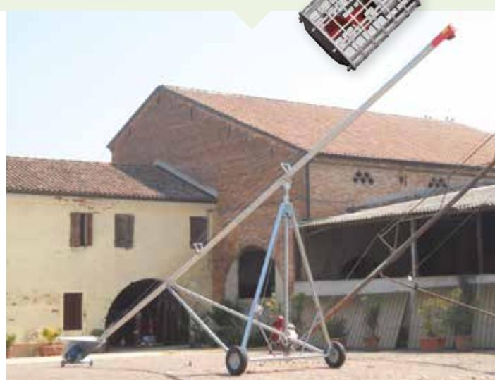
Convogliatori a coclea per Granaglie & Cereali progettate per essere modulari e componibili si adattano a diverse applicazioni. La spirale all'interno della coclea è auto-centrante. Di serie trasmissione a cinghie trapezoidali con motore elettrico 3fase, con velocità standard RPM930 / RPM780 / RPM600.
